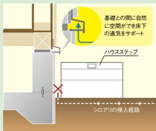
現場作りの踏台は基礎から切り離しにくく、打ち継ぎ部分や穴の処理が困難なため、埋め戻しの土などを通してシロアリが侵入してしまうケースもあります。ハウスメップは基礎部分から離して設置するため、化粧モルタルで基礎の打ち継ぎ面をしっかりと塞ぐことで、シロアリの侵入経路をしっかりとカット。また、水切りからも距離を開けることで、床下換気を妨害しません。
